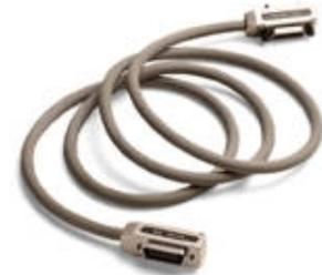
二重シールドにより、EMI(電磁界障害)や RFI(電波干渉)を抑えています。AWG#28 のツイステッドペアケーブルで構成されているため、近接導体間の漏話を減少させます。さらに沿え線(drain wire)も取り入れて、優れた接地パスを提供します。柔軟性に富むコンパクトな構成なので、パッキングする際にも手間がありません。
