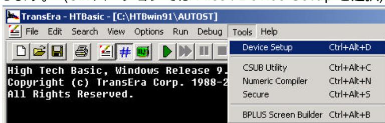
LOAD BIN や同等のコマンドを使い、ISC の指定によりロードされたドライバは[Device Setup]ダイアログボックス内のドライバリストに表示されます。ここにはドライバの名前、バージョン、説明、ステータスおよびドライバに割り当てられた ISC が表示されます。
